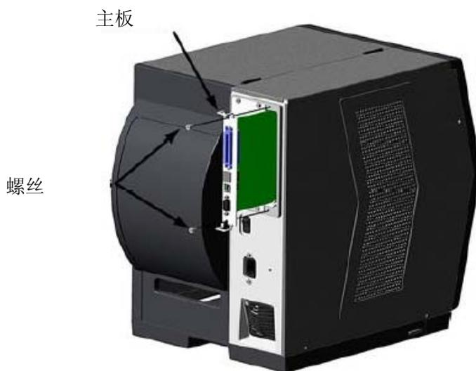
3. 旋松并拆除将“主板”固定到打印机的两个螺丝；
